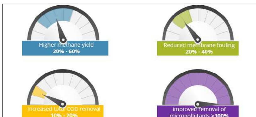
Fig. 2. Indicateurs clés de performance de l'e-GAnMBR par rapport au réacteur de contrôle AnMBR (valeurs dérivées des études mentionnées dans Chen, et al 2023).
