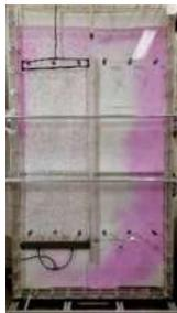
Fig. 1. Répartition expérimentale du traceur à  $t = 5 \text{ s}$  après injection de soude permettant de mettre en évidence les zones de recirculations
