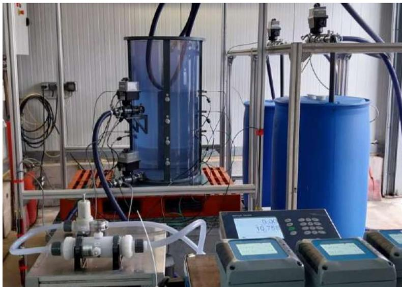
Fig. 2. Photographie du dispositif pilote (cuve de 200 L) pour l'étude des mélanges incompatibles avec des réactions équivalents
