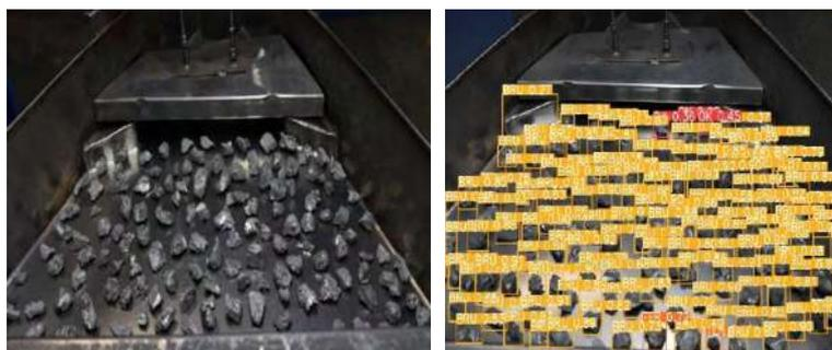
Fig. 1. Support de correction de l'échantillon de grains par tri (à gauche) et résultats de l'outil développé (à droite)
