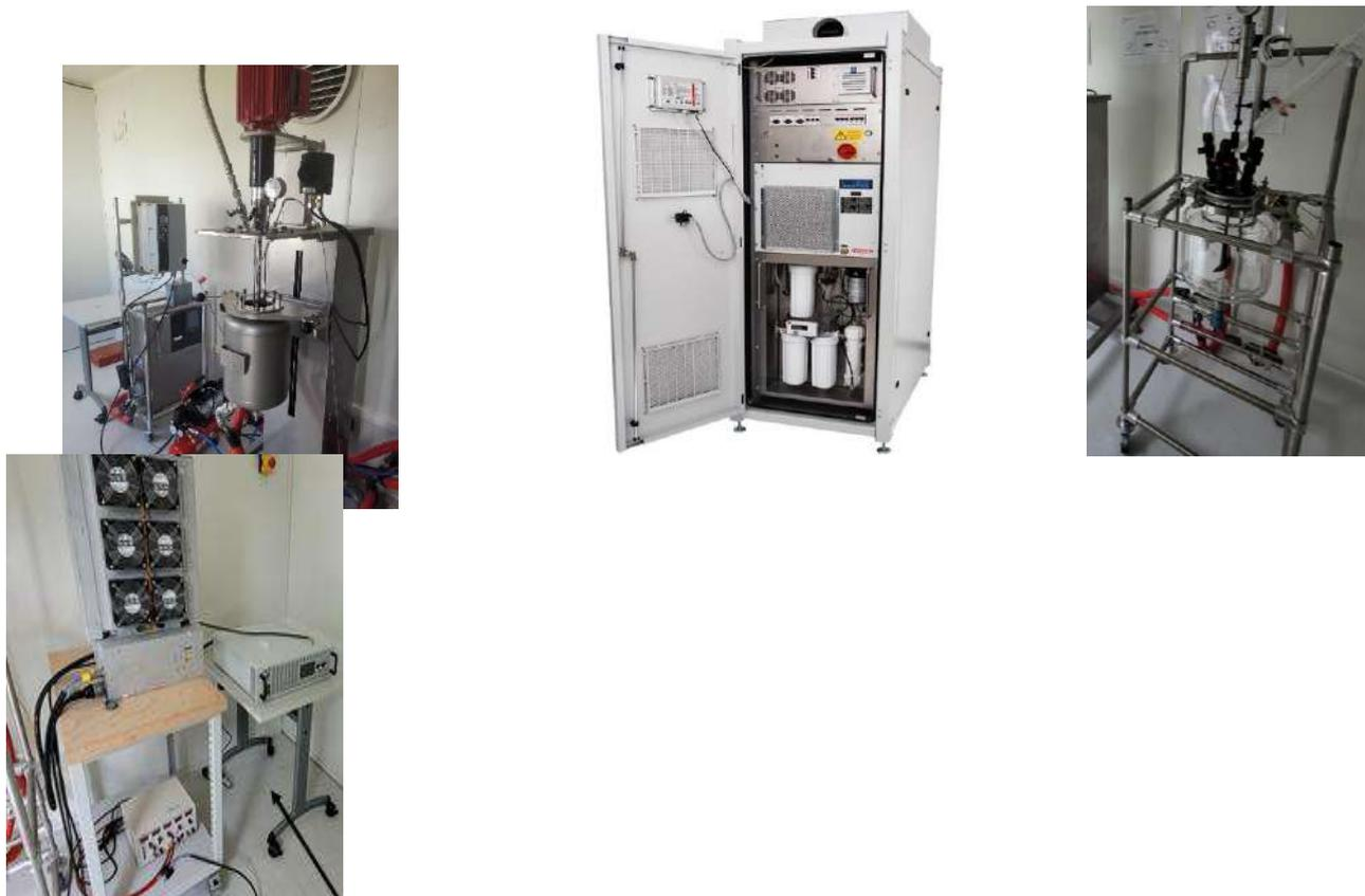
Fig. 2. Matériels de la chaîne de valeur. De gauche à droite : réacteur d'hydrogénation, électrolyseur, réaction de déshydrogénation, pile à combustible.
