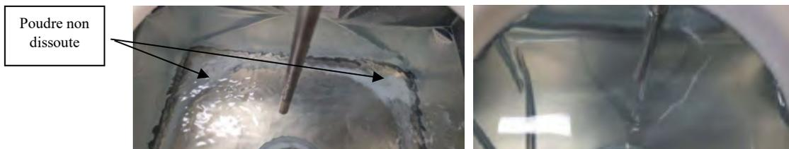
Fig. 3. Visualisation de l'échec (gauche) et du succès de la dissolution (droite) dans la cuve semi-industrielle de démonstration de la méthode.
