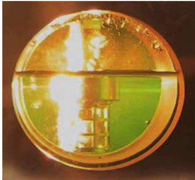
Fig. 1. Réaction d'une bille de 2 g de sodium dans une solution d'acétate de sodium à 1 mol/L
