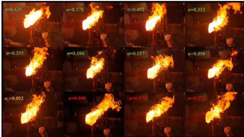
Fig. 2. Visualisation de flammes pour différentes valeurs du nombre de cavitation  $\sigma$  (buse 2.25 80W)
