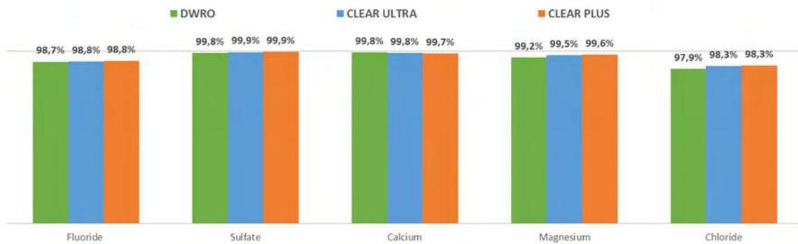
Fig. 1. Performance d'élimination des ions avec les trois membranes biomimétiques
