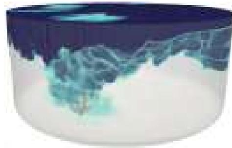
Fig. 1. Visualisation de la dispersion du traceur liquide lors de l'étude numérique du mélange aux grandes échelles dans la cuve industrielle actuelle.
