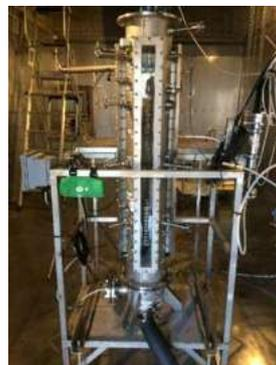
Fig. 2. Dispositif DIANNA pour réaliser la dissolution de pains de soude
