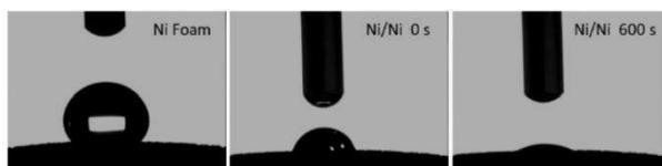
Fig. 3. Test de mouillabilité de l'électrode de nickel et l'électrode de nickel modifiée avec  $Ni(OH)_2$
