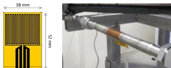
Fig. 1. Représentation schématique (gauche) et photographie (droite) de la sonde de détection.
