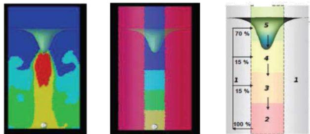
Figure 1. Modélisation et découpage en zones du réacteur vortex.
