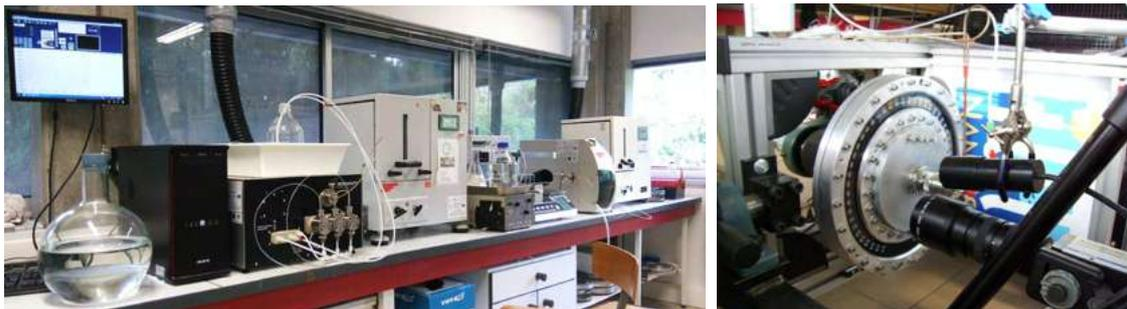
Fig. 1. vue d'équipements de CPC au laboratoire GEPEA (à gauche) et de la maquette de visualisation des écoulements à l'intérieur des colonnes rotatives (à droite)
