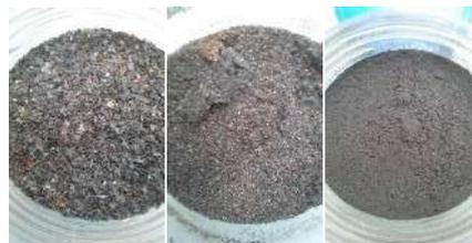
Fig. 2. Fractions granulométriques du broyat de déchets de cartes électroniques (échantillon broyé à  $750 \mu\text{m}$  ; de gauche à droite :  $> 0.8 \text{ mm}$  ;  $0.8 \text{ mm} - 0.4 \text{ mm}$  ;  $< 0.063 \text{ mm}$ )
