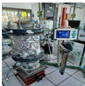
Fig. 1. Gauche : Structure d'un des MOF sélectionné comportant des molécules de CO<sub>2</sub> piégées dans ces tunnels et les molécules d'azote de pouvant pas y accéder (C=gris, N= bleu, O= rouge, F= vert) ; droite : photo du réacteur imaginé et conçu pour la capture de CO<sub>2</sub> atmosphérique.
