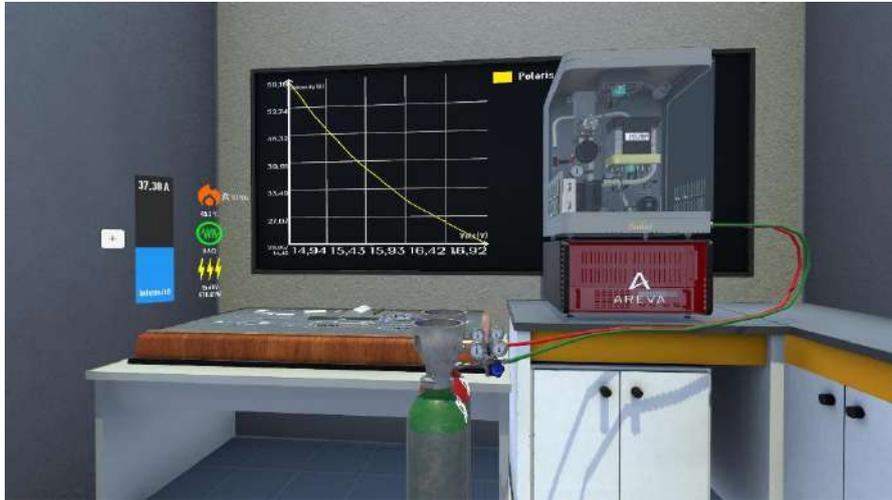
Fig. 1. Scénario de traçage de la courbe de polarisation de la PAC
