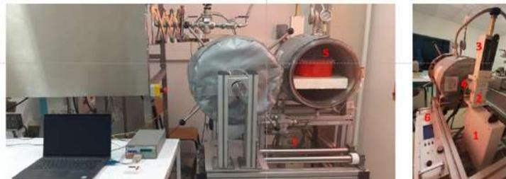
Fig. 1. Éléments constitutifs de l'équipement pilote de traitement par micro-ondes.
